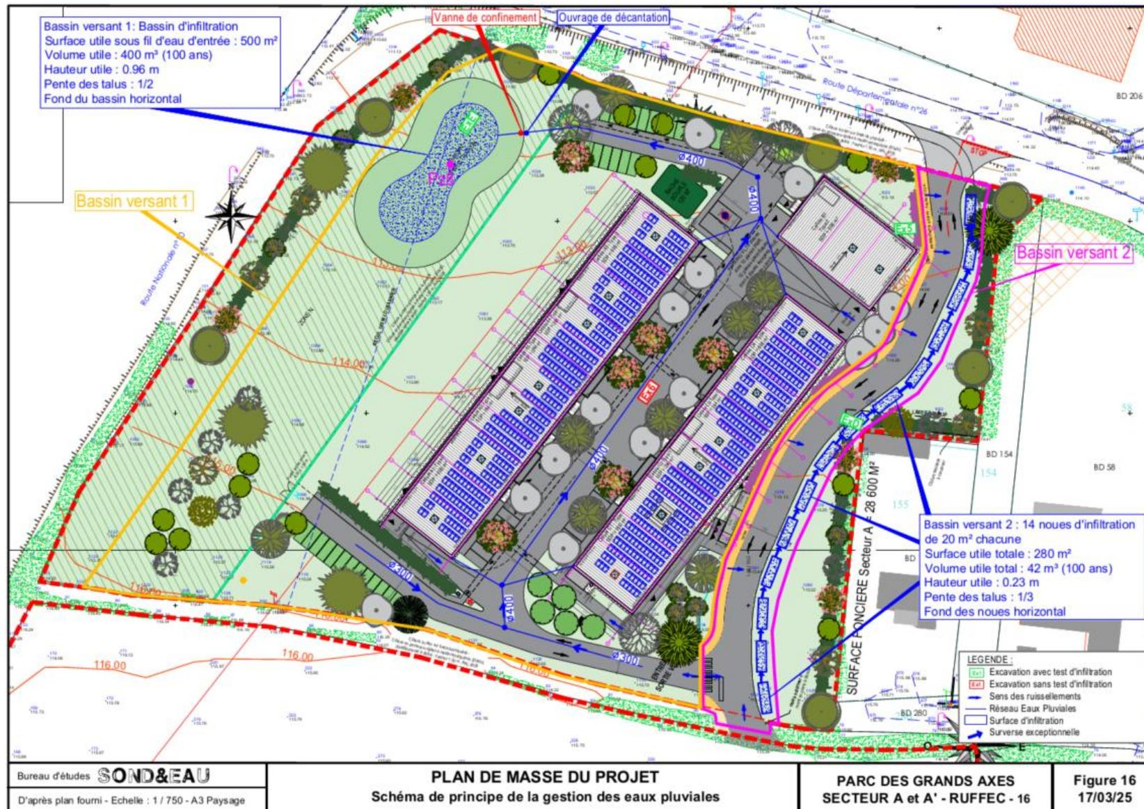
Figure 13. Localisation des ouvrages de gestion des eaux pluviales - secteur B' (Source : Sond&eau)
